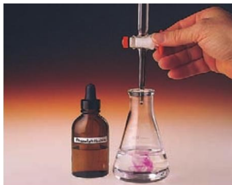
Gambar 108 Titrasi larutan HCl dengan Larutan NaOH menggunakan indikator phenolphthalein
