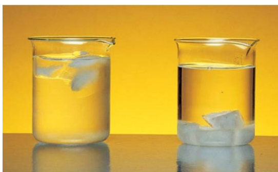
Gambar 50 Kiri: Es batu terapung dalam air. Kanan: Benzena padat tenggelam ke dasar cairan benzena (Sumber: Chang, 2010: 471)
