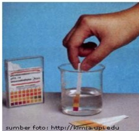
Gambar 106 Pengukuran pH larutan menggunakan kertas indikator universal ( http://www.google.com )
