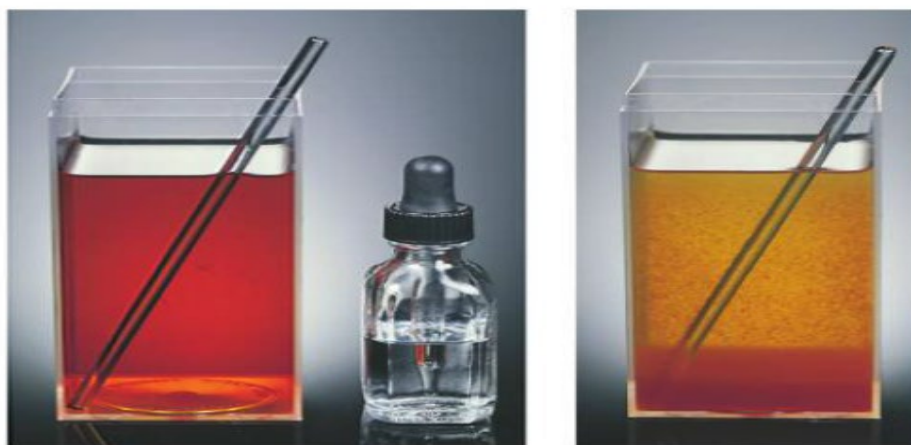
Gambar 121 Koagulasi besi(III)oksida, diperoleh dengan menambahkan \text{FeCl}_3 ke air panas.
