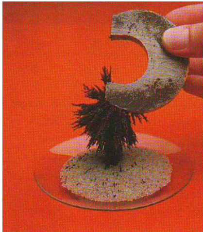
Gambar 1. 28 Memisahkan serbuk besi dari campuran heterogen (Sumber: Chang, 2008, General Chemistry 5 th )
