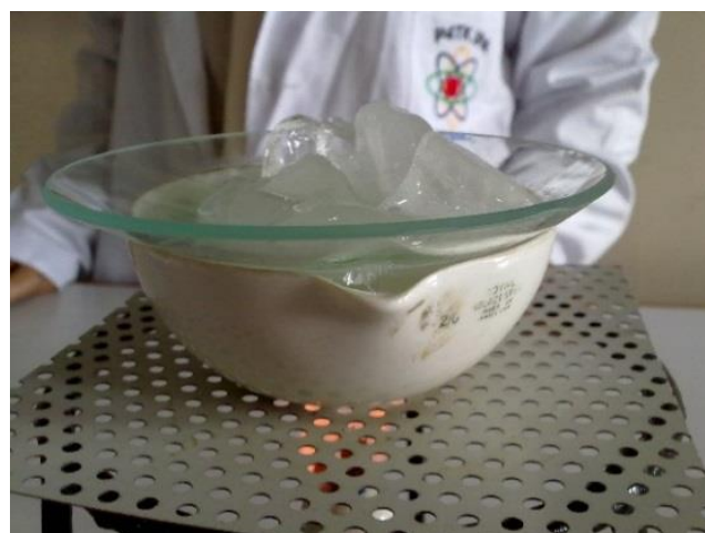
Gambar 1. 30 Proses Sublimasi Kapurbarus Sumber : Dok. PPPPTK IPA
