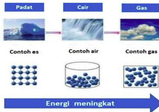
Gambar 1. 4 Tiga keadaan materi: padat (s), cair (l) dan gas (g) serta ilustrasi mikroskopik susunan partikel materi di dalamnya. Sumber: http://docplayer.info
