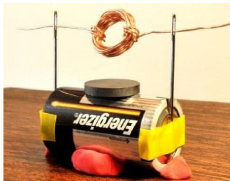
Gambar 3. 54 Penerapan gaya Lorentz pada motor listrik sederhana Sumber: www.gagalenyilih.com
