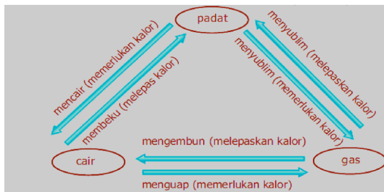
Gambar 2. 40 Diagram perubahan wujud zat di pengaruhi kalor
