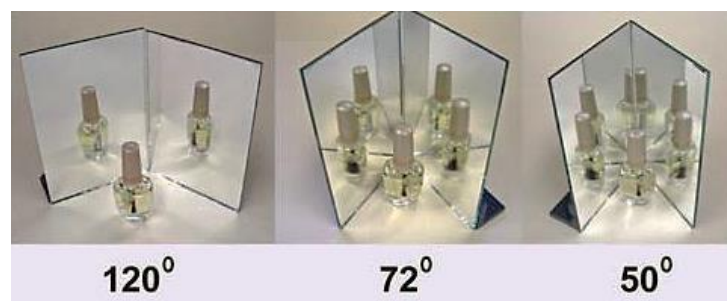
Gambar 3. 20 Pembentukan pada Dua Buah Cermin Datar Sumber: fisikaabc.com
